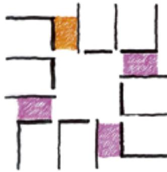
Rakennus muodostuu neljästä samanlaisesta modulista, joissa on kaksi ryhmähuonetta sekä hoitohuone. Pitkät räystäät varjostavat ryhmähuoneita sekä suojaavat terasseja, jonne tilat voidaan avata.
